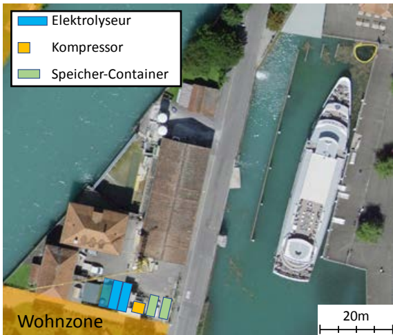
Abbildung 34: Lageplan und potenzieller Aufbau von zwei resp. drei 200 kW Elektrolyseuren beim Kraftwerk Interlaken (Kanal)
